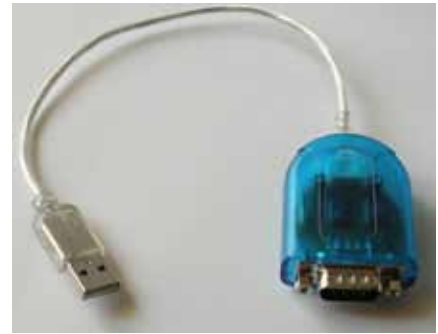
図 3.2 RS 232 - USB 変換器
