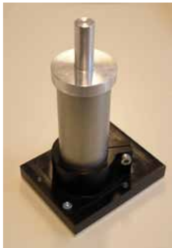
図3.13 マイクロスポットモニタ対物レンズ 取り付け補助器具付き
